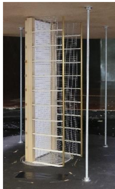
Abb. 2.4: Bild des Sektionsmodells für die Kraftmessung – Versuchskonstellation „Vereisung Gitterrost“
