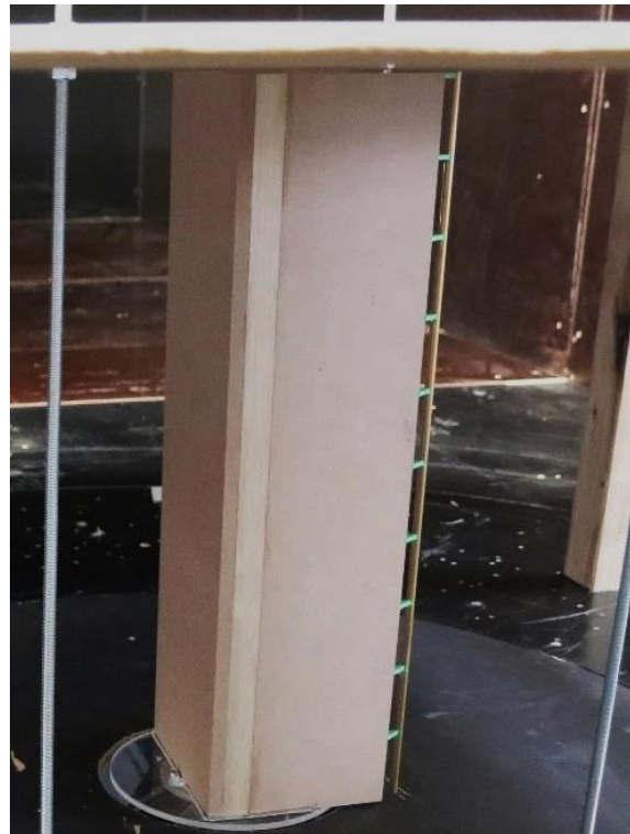
Abb. 2.3: Bild des Sektionsmodells für die Kraftmessung – Versuchskonstellation „Vollständige Vereisung“
