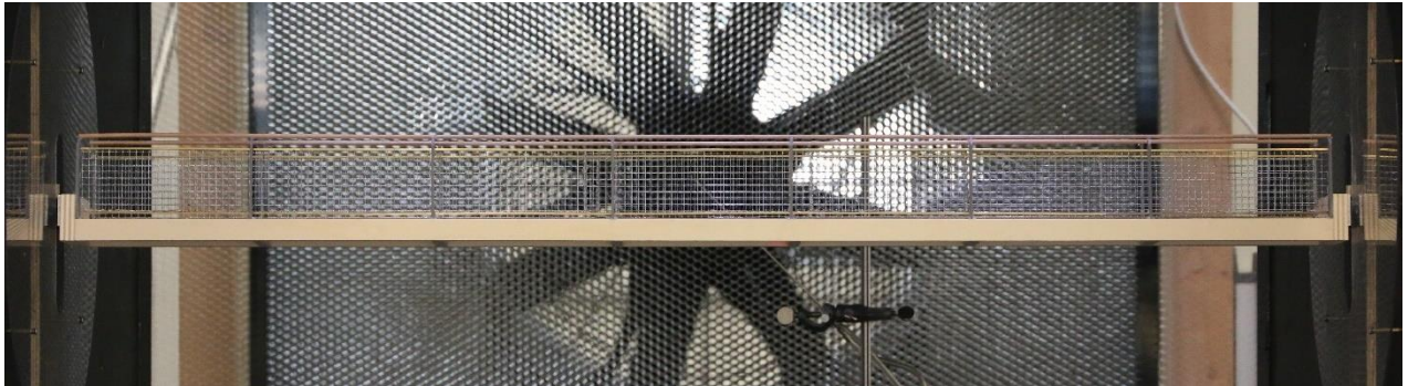
Abb. 2.9: Bild des Sektionsmodells für die aeroelastischen Windkanalversuche – Versuchskonstellation „Vereisung Gitterrost“
