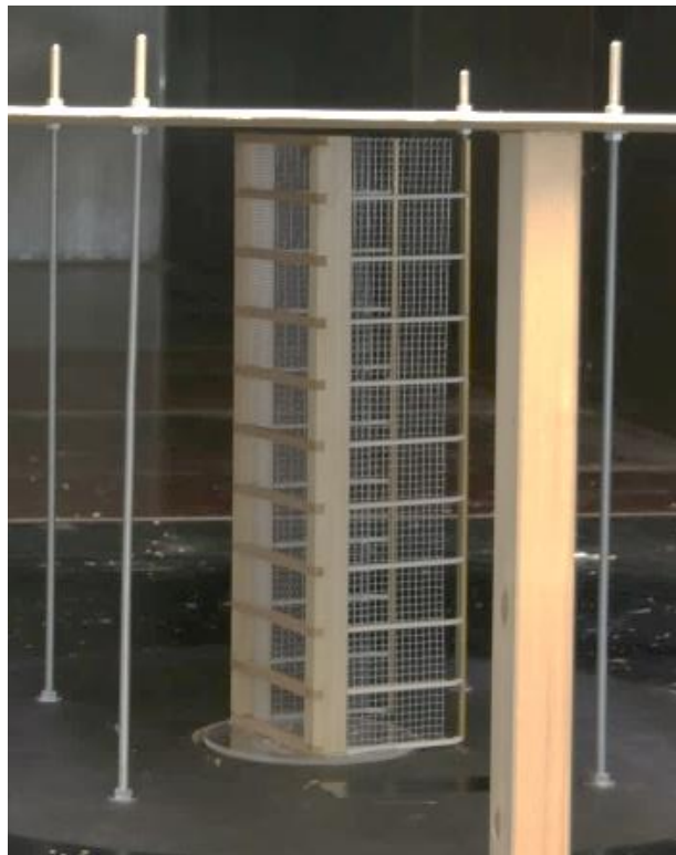
Abb. 2.2: Bild des Sektionsmodells für die Kraftmessung – Versuchskonstellation „Ohne Eisansatz“
