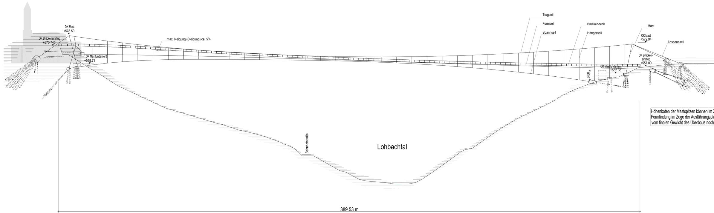
Höhenkoten der Mastspitzen können im Zuge der finalen Formfindung im Zuge der Ausführungsplanung abhängig vom finalen Gewicht des Überbaus noch variiert werden.
